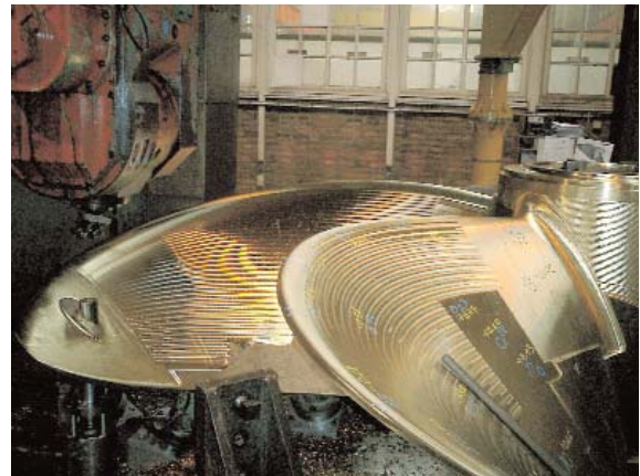
Hélice de barco mecanizada con 5 ejes por UIGM (Le Creusot, Francia).
